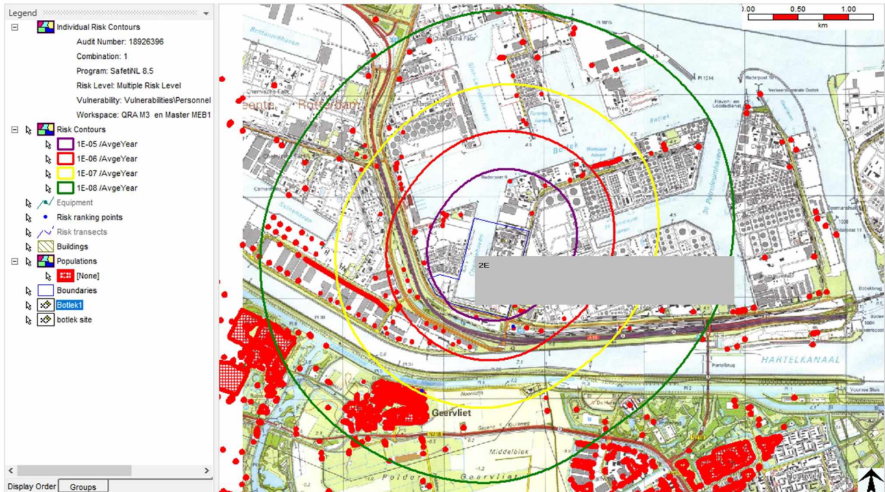
Figuur 5: De PR contouren voor de aangewezen installatiedelen van MEB 1 aangevraagde situatie
